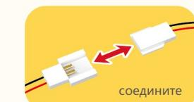
Подсоедините клемму питания и клеммный
