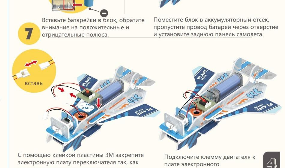
С помощью клейкой пластины 3М закрепите электронную плату переключателя так, как показано на рисунке, подключите клемму питания к клемме электронной платы.
