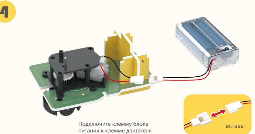
Подключите клемму блока питания к клемме двигателя
